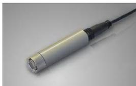
■ **TURBINA DE INSERCIÓN.** Turbina tangencial para medición de caudal y volumen, dentro de un rango de velocidades de flujo de 1:10, desde 0,5 hasta 5 m/s. Su robusto cuerpo en acero inoxidable permite una larga vida útil en aplicaciones con líquidos agresivos.
